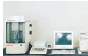
洛氏硬度標準試驗機SHT-31 (機體與操作面板除外其餘為特別附屬品)
