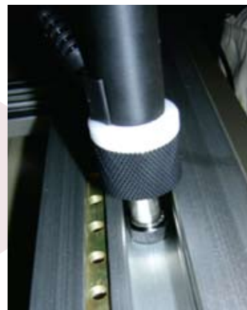
●隙縫或溝槽、輕微不均勻表面的硬度試驗
