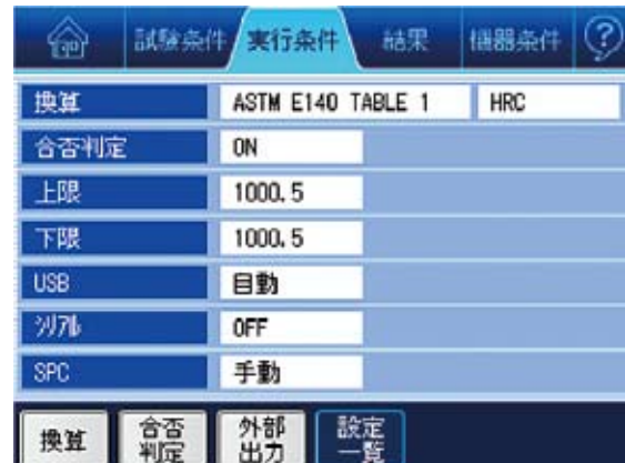
選擇換算單位，輸入合格判定的設定值，設定外部輸出。
