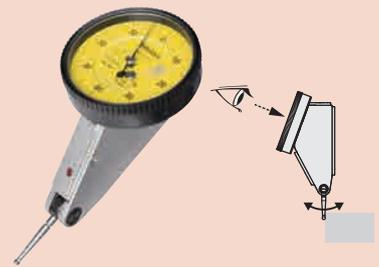
橫型：測針橫向接觸到橫向放置的圓棒端面，故可從正面讀取刻度。
