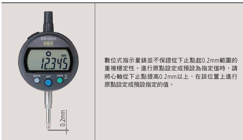
數位式指示量錶並不保證從下止點起0.2mm範圍的重複穩定性。進行原點設定或預設為指定值時，請將心軸從下止點提高0.2mm以上，在該位置上進行原點設定或預設指定的值。
