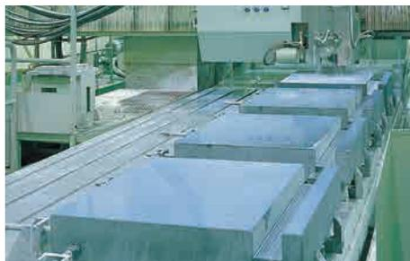
使用大型研削盤來研削三次元測定機用台座
