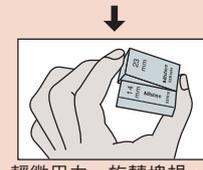
輕微用力、旋轉塊規。滑動時，可感覺到貼合狀態。
