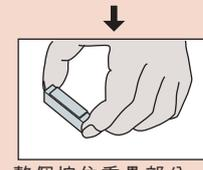
整個按住重疊部分，並滑動塊規，使測定面疊合。
