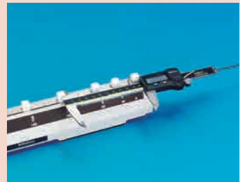
游標卡尺的內側精度檢查
