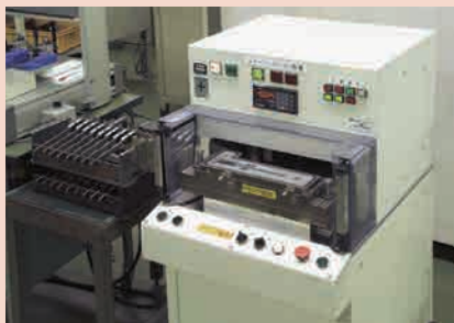
ABS防水卡尺的空氣洩漏試驗裝置
